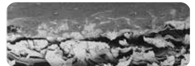
Nanofaser-Medien Querschnitt (600x)
